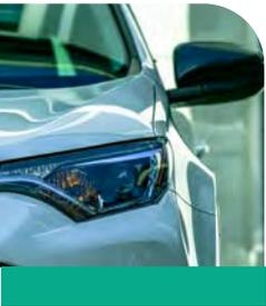
ポリカーボネートは、交通安全の重要な側面から、あらゆる車両のヘッドライトに使用される業界標準となっています。ポリカーボネートが外殻として使用され、光源を保護するのは、ポリカーボネートが優れた耐衝撃性を持ち、路上の破片や石が当たっても、割れたり砕けたりすることなく逸らすからです。これは、事故の際に歩行者の安全を守るために特に重要です。ポリカーボネートの透明性、軽量性、成形性、設計の自由度は、急速に進化する電気自動車やセンサー技術を統合することも可能にしています。
