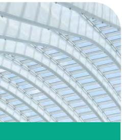
透明なポリカーボネートシートにより、建物内に自然光を取り入れることができます。ポリカーボネートは他の建材に比べて非常に軽量であるため、輸送や設置に必要なエネルギーが少なく済み、大胆なデザインや大型化も可能です。ポリカーボネートは、割れにくく耐衝撃性に優れた素材でありながら、実用的な難燃性を兼ね備えているため、建築物の安全性に関わる重要な防火基準や規制をクリアしています。
